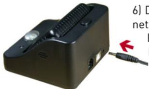
Setzen Sie den e\*Alarm VI, wie unten gezeigt, in das Ladegerät ein. Lassen Sie das Gerät zunächst mindestens 4 Stunden lang aufladen.
