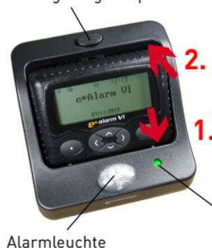
1. Melder mit der Unterkante zuerst in das Ladegerät einsetzen.
